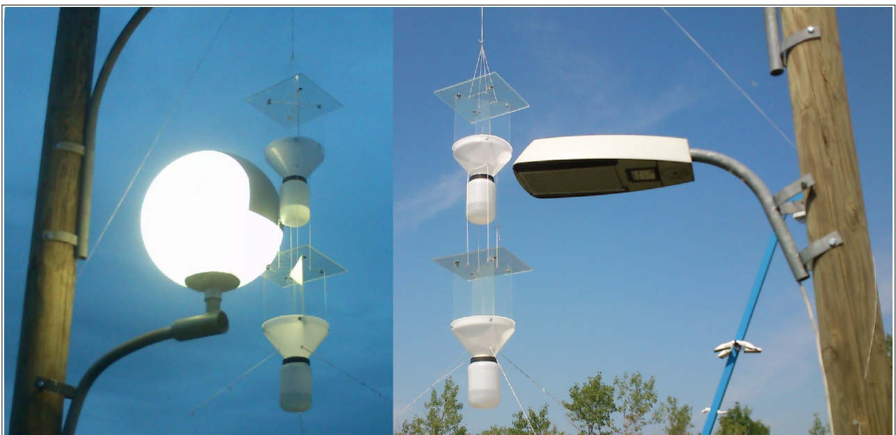
Abbildung 3.6.1: Leuchtentypen der zweiten Untersuchungsphase. Links: Kugelleuchte mit zwei Lichtfallen. Man beachte, dass der obere mittlere Bereich der Kugelleuchte mittels Zinkspray lichtundurchlässig gestaltet wurde. Rechts: Kofferleuchte mit zwei Lichtfallen. Man beachte, dass die Lichtaustrittsfläche mittels Lochblech modifiziert wurde (© Martin Soneira, Juli 2012).
