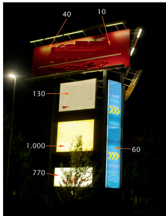
Abb. 2.15 Leuchtpylon mit Angaben zur Leuchtdichte in cd/qm
